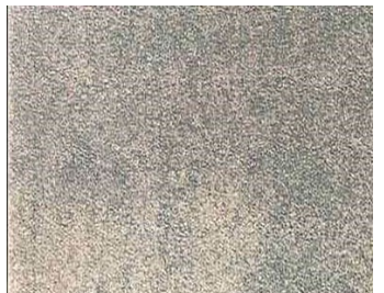
État D Sablé à Sa 2
